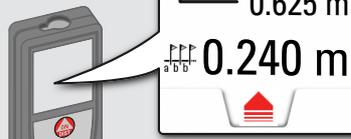
Při přibližování k vymezenému bodu na méně než 0.1 m začne přístroj pípat. Funkci lze zastavit stisknutím tlačítka vymazání a vypnutí.
