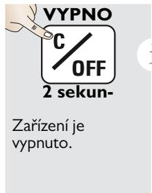
**Zařízení se automaticky vypne, pokud po dobu 180 sekund nestisknete žádné tlačítko.**
